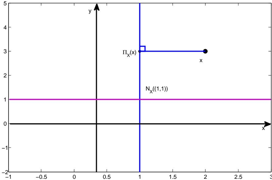
FIGURE 2 – Ensemble  $X$ , cône normal  $\mathcal{N}_X((1, 1))$  et projection  $\Pi_X((2, 3))$ .
