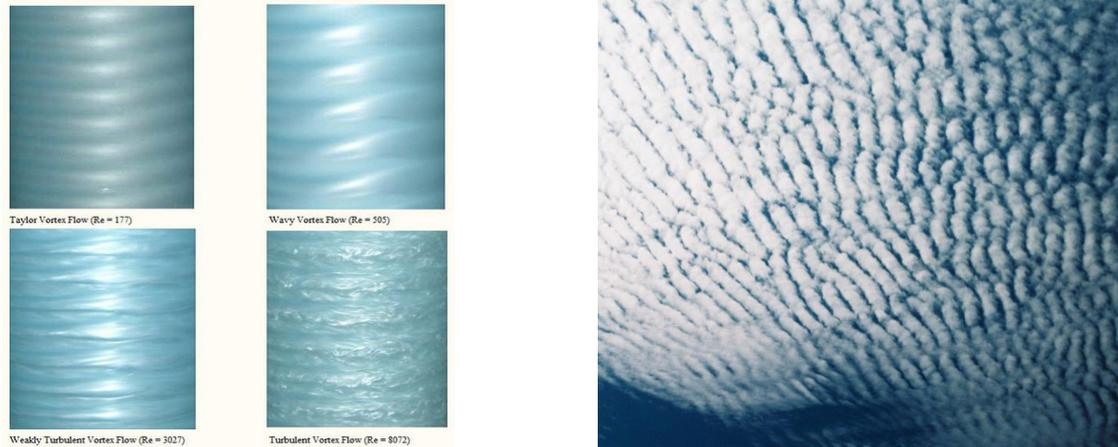
FIGURE 5 – A gauche : rouleaux de convection dans un écoulement de Couette Taylor. A faible nombre de Reynolds ( $Re = 177$ ) les rouleaux sont réguliers et se déstabilisent quand le nombre de Reynolds augmente ( $Re = 8072$ ) A droite : des “rues de nuages” résultats de l’instabilité de Rayleigh-Bénard.
