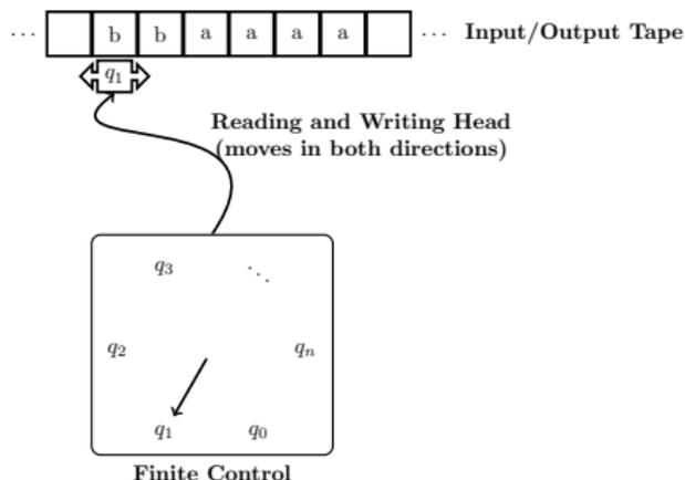
Étant donné un ruban  $R \in \Gamma^{\mathbb{Z}}$  et une machine à la position  $i \in \mathbb{Z}$  et l'état  $q \in Q$ , la machine calcule  $\delta(q, R_i) = (q', a, \epsilon)$ . Puis elle écrit  $a$  à la position  $i$ , se positionne en  $i + \epsilon$  et se place à l'état  $q'$ .
