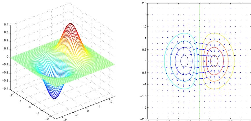
FIGURE 3.2 – Le graphe, les lignes de niveaux, et le gradient de l'application  $f : (x, y) \mapsto x e^{-(x^2 + y^2)}$ .
