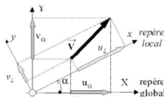
$$\begin{Bmatrix} u_L \\ v_L \end{Bmatrix}_{Local} = \begin{bmatrix} c & s \\ -s & c \end{bmatrix} \cdot \begin{Bmatrix} u_G \\ v_G \end{Bmatrix}_{Global}$$
