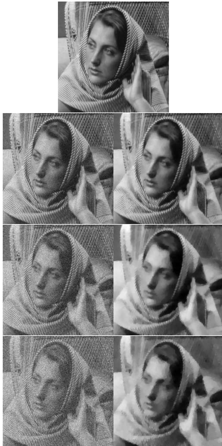
FIGURE 3.3 – En haut, l’image souhaitée puis de haut an bas : à gauche l’image bruitée et à droite l’image débruitée pour des bruits d’écart type 10, 20, 30.
