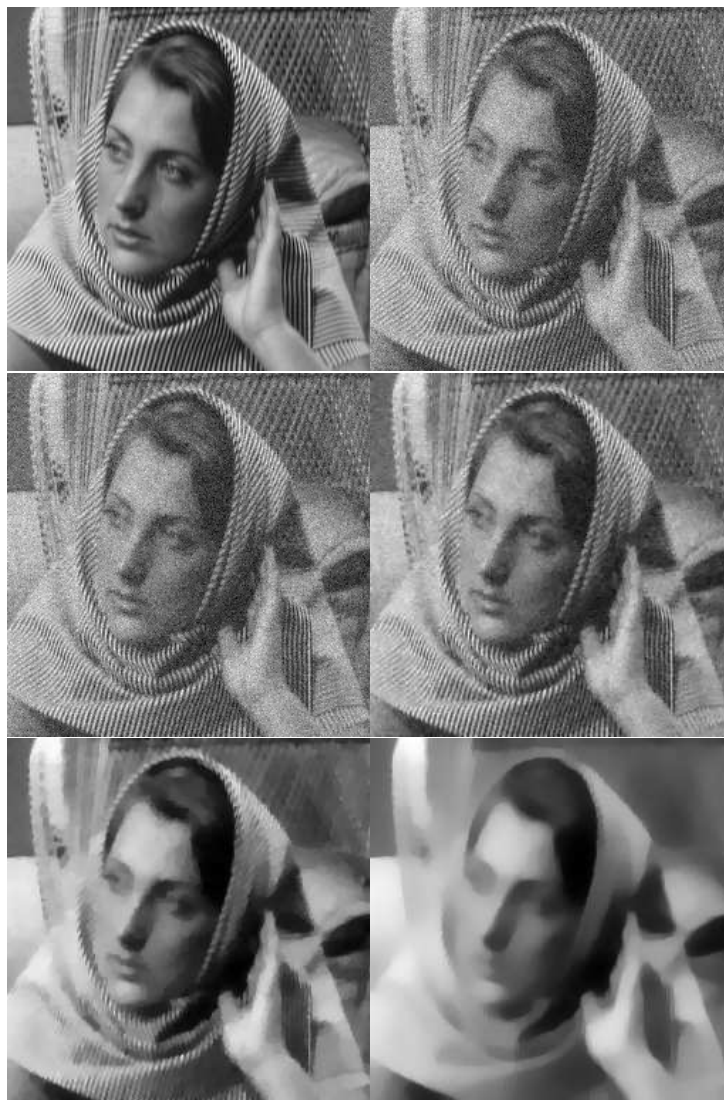
FIGURE 3.4 – En haut, à gauche l'image souhaitée et à droite l'image bruitée avec un bruit d'écart type 20. Puis, de haut en bas et de gauche à droite, l'image débruitée pour \lambda = 0.5, 0.05, 0.017 et 0.005 .
