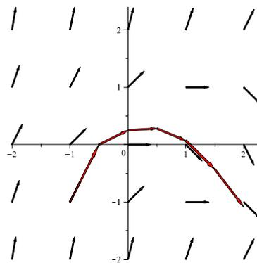
FIGURE 1.5 – Représentation d'une solution via la méthode d'Euler.
