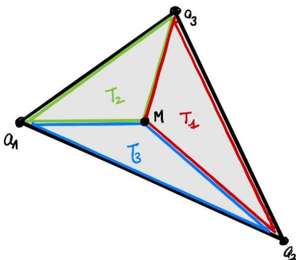
On a  $\lambda_i = \frac{|T_i|}{|K|} \rightarrow$  cela donne un moyen algorithmique simple pour calculer les  $\lambda_i$  dans une m\^ethode \\'el\'ement finis.
