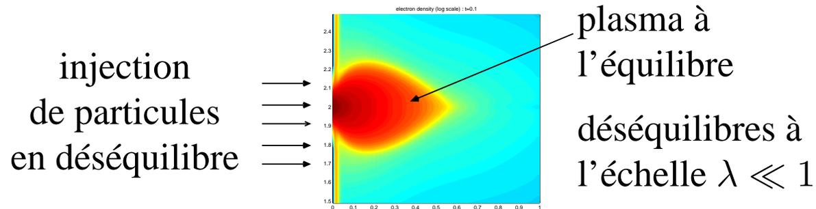
faible masse des électrons + pression  $\Rightarrow$  accélération des électrons
