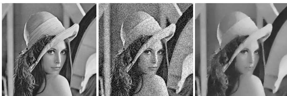
FIG. 5.4 – De gauche à droite : image originale dans [0, 1] - image originale + bruit U([-0.2, 0.2]) - image débruitée avec p = \infty et \alpha = |b|_{L^\infty(Y)} .
