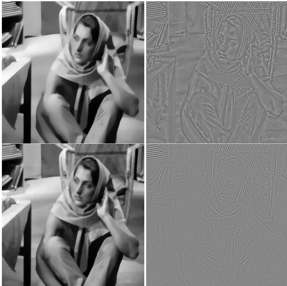
FIG. 6.2 – Décomposition en partie géométrique et en partie oscillante. Haut : modèle de Y. Meyer. Bas : modèle de Osher-Solé-Vese
