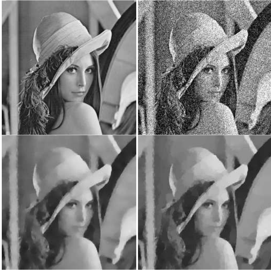
FIG. 7.1 – HG : image originale - HD : image bruitée - BG : solution de (7.2) en utilisant l'algorithme Algo3 et en posant \mu = 10^{-3} - BD : solution exacte de (7.1) obtenue en appliquant Algo1 jusqu'à convergence
