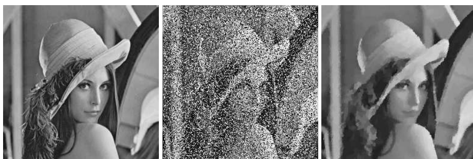
FIG. 5.3 – De gauche à droite : image originale (valeur dans [0, 1] ) - image bruitée (bruit poivre et sel 40%) - image restaurée par variation totale avec p = 1 et \alpha = |b|_{L^1(Y)} .
