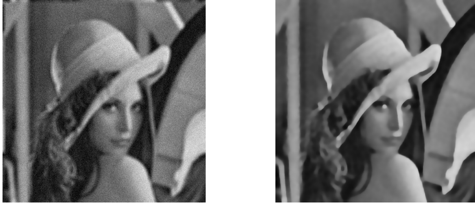
FIG. 12 – Image floutée et bruitée avec un bruit gaussien de \sigma^2 = 0.05 , déconvolution en norme 2. Critère d'arrêt : 100 itérations, 24.1 secondes avec Matlab et 838 ms avec CUDA dont 253 ms de copie en mémoire
