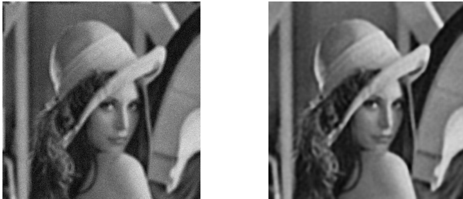
FIG. 11 – Image floutée et bruitée avec un bruit gaussien de \sigma^2 = 0.05 , déconvolution en norme 1. Critère d'arrêt : 100 itérations, 32.3 secondes avec Matlab et 824 ms avec CUDA dont 252 ms de copie en mémoire
