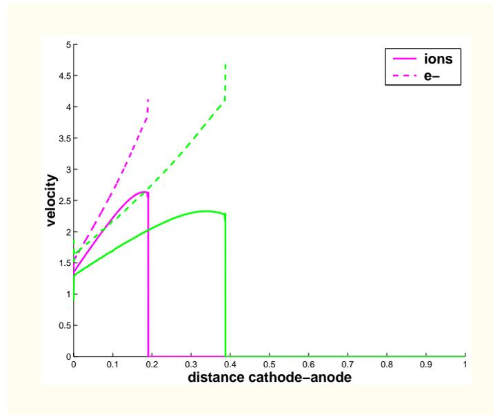
Vitesses des électrons et des ions dans le plasma,
