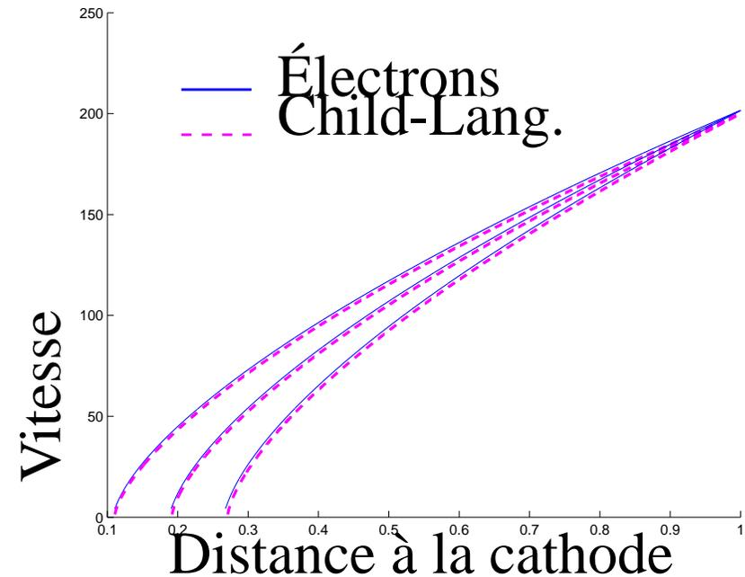
Densité et vitesse électroniques dans le faisceau,
