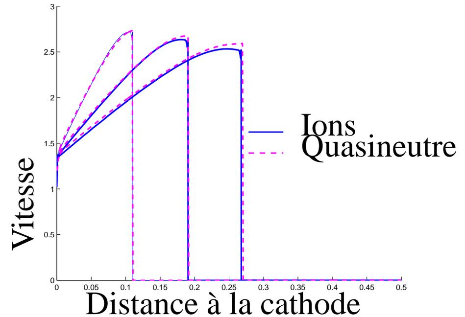
Densité et vitesse ioniques dans le plasma, modèles
